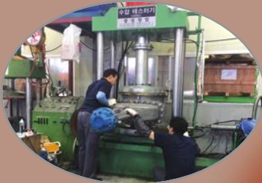
⑦ 수압 테스트 Water Pressure Test
